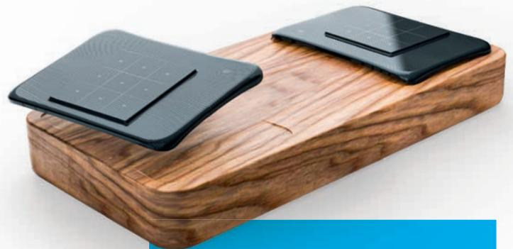
Das im Projekt «Drako» entstandene Touch-Panel gibt Ausblicke auf zukünftige Entwicklungen: Es ermöglicht eine mühelose Navigation und eine intuitive Interaktion. Über eingebaute LEDs erfolgt ein visuelles Feedback über den aktuellen Status der Bedienung.
