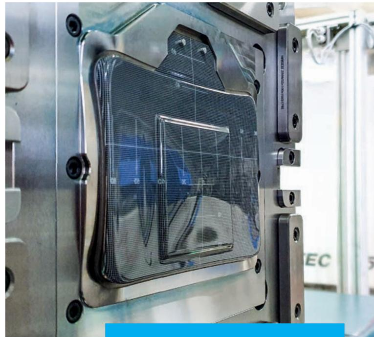
Für die erste Bemusterung des Drako-Spritzgusswerkzeugs wurden Folien mit einem Raster verwendet, um Rückschlüsse auf die Verzerrung des Materials im Verlauf der Fertigungsschritte ziehen zu können und um mögliche Verwaschungen durch den Spritzguss-Prozess ausfindig zu machen.
